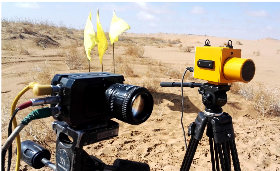
XGK-HY-12 型火光触发器配接高速相机
